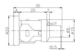
Rating - 10A(UL/CSA/VDE) 定格 6.3A(SEMKO) Matching Fuse ø5.2\*20 適合ヒューズ <sup>0</sup>5.2\*20 Thickness of mounting board . 0.8/1.0/1.2 取 付 板 厚 1.6/2.0
